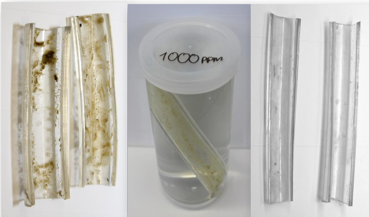
PVC-tube med biofilm før og etter desinfeksjon med Sanosil 1000 ppm løsning.
